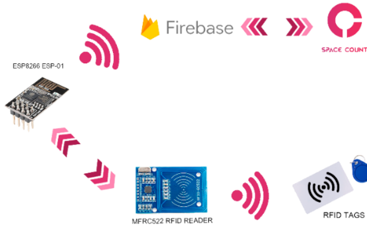
Figura 4. Ciclo de Funcionamento do Sensor para gestão de ambientes coletivos
