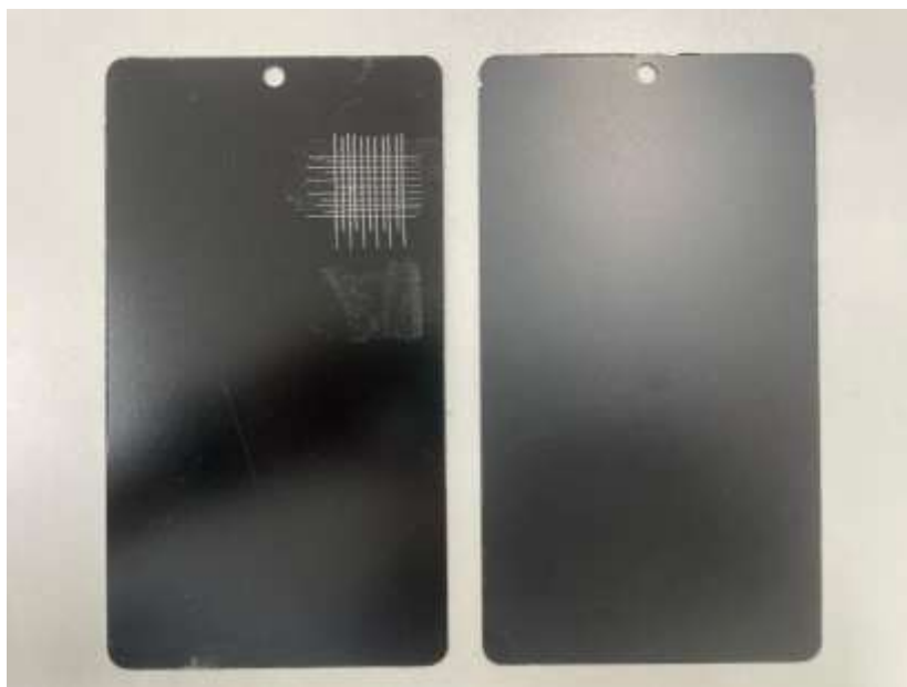
Figura 3. Placa metálica pintada com tinta preta formulada a partir da resina de PET reciclado
