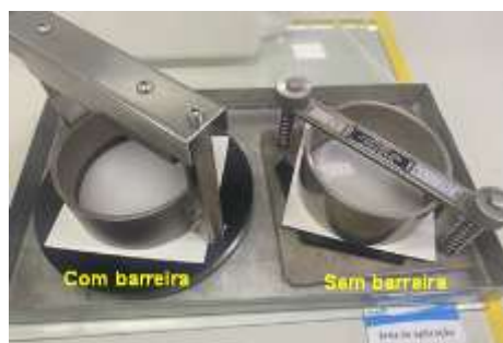
Figura 4. Ensaio de Resistência à Penetração de Óleo ( Cobb Oil )
