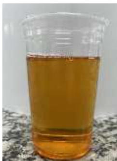
Figura 4. Resina obtida a partir do PET reciclado
