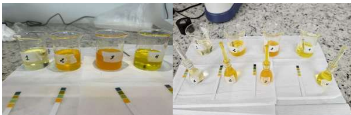
Figura 9– Exemplo ensaio de perda de massa segundo ASTM G1
